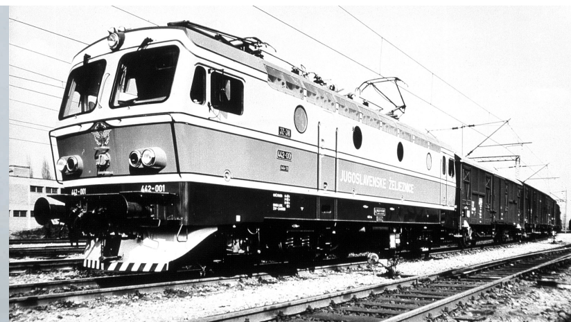
TIRISTORSKA LOKOMOTIVA 442 / UPRAVLJAČNICA DIZAJN: Zlatko Kapetanović i razvojni tim Končar PROIZVODNJA: OOOR Rotacioni strojevi Zagreb, 1981.
