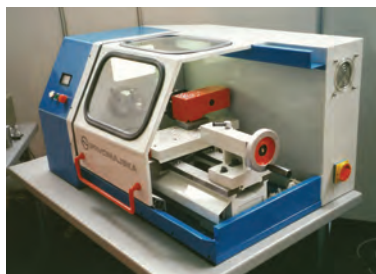
Numerički upravljana stolna tokarilica Tabturn 100, Prvomajska Golubovec, 1989.
