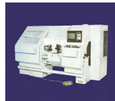
Tokarilica TN-480, 1979., Prvomajska Raša, CNC tokarilica s vlastitim dizajnerskim i konstrukcijskim rješenjem
